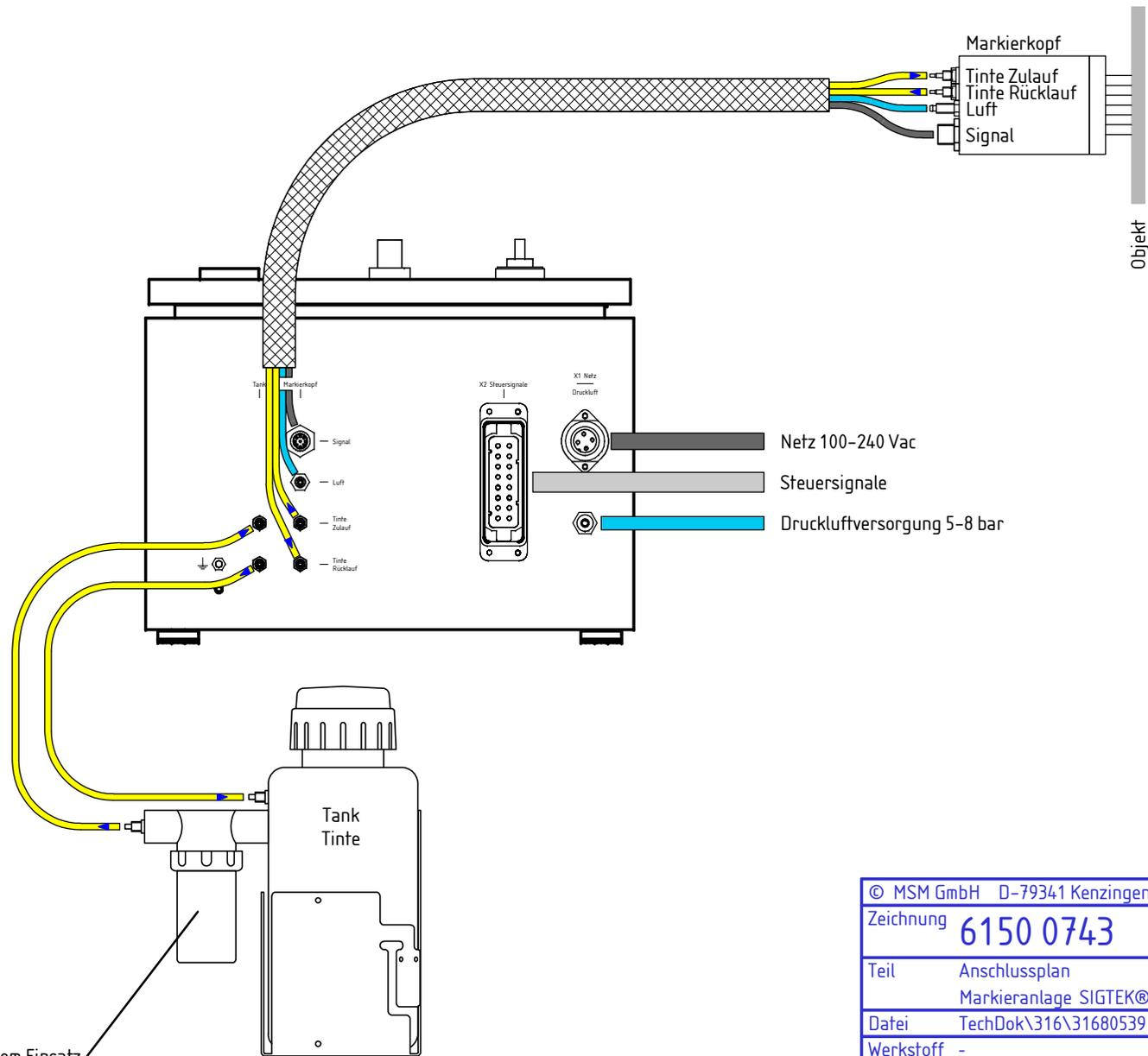
Filter mit auswechselbarem Einsatz
